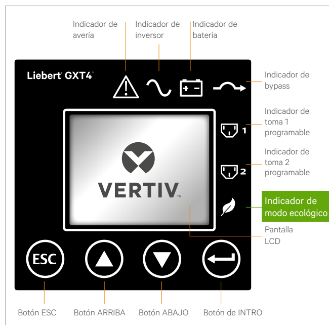
Figura 5: Los indicadores LED del panel frontal indican el estado de la toma.
